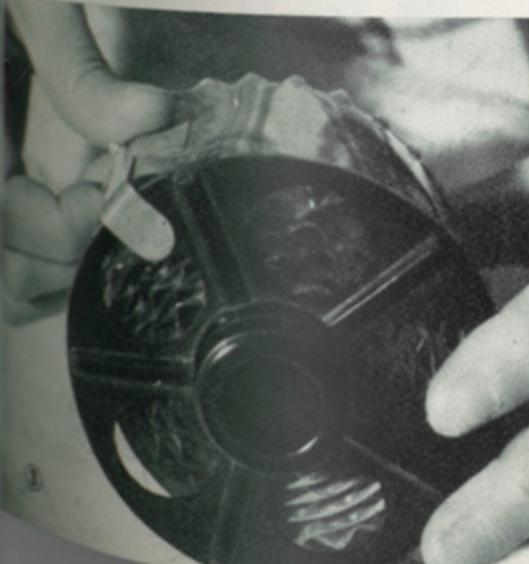
③正しく巻き終ると写真のような状態に、ベルトの最後の止め金を中棒のへりに止めて固定します。もつともタンクにもいろいろと違った型がありますが、現像のムラを防ぐためにこの等間隔を保つことが大切です。
