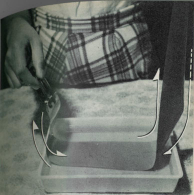
(6) 中間水洗の後は定着です。一方のクリップをはずして、フィルムの自然の巻きぐせを利用して、定着液の中にくるくると巻き込ませる方法をとつても良いでしょ。写真のようにクリップをつけたままでも良いのです。約10分位経つたら普通の電燈をつけて明るくしても大丈夫です。定着は、乳白色の未感光乳剤が溶け出して、その部分が透明になるまでおこないます。
